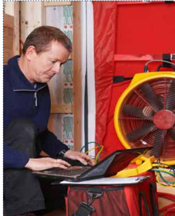
Beim Neubau als Nachweis über die dichte Gebäudehülle, die Blower Door Messung
